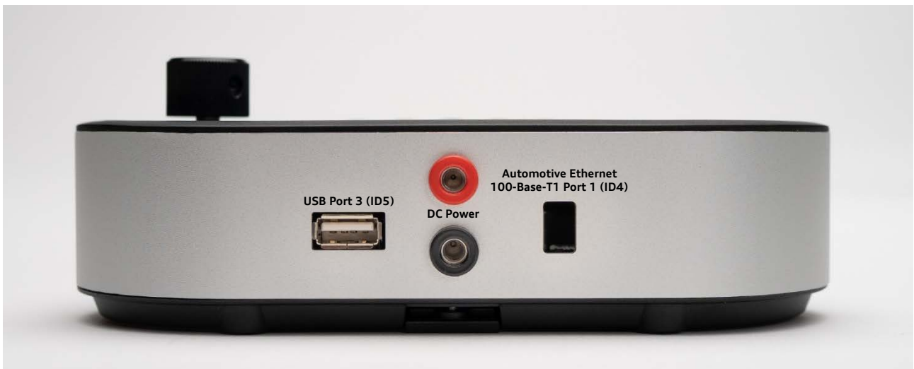
Abbildung 3 - SUSAN advanced Port und Interfacebezeichnung, Rückansicht.
